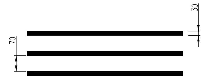
减速带标线布设大样图
